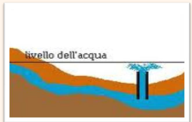
Esempio di un pozzo artesiano
